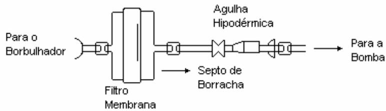
FIGURA 2a - Controle de vazão com orifício crítico
