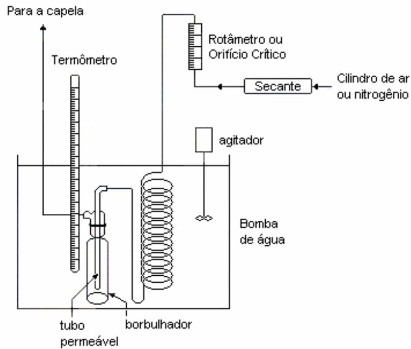
FIGURA 3 - Aparelhagem para calibração do Tubo Permeável
